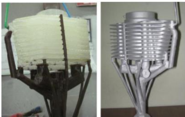
Сурет – 15 ІЖҚ құю жүйесі бар SLA – Quick Cast моделі мен алюминий құйма
