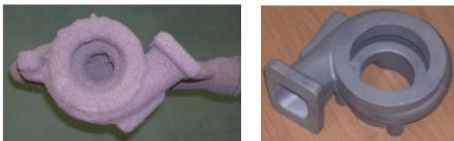
Сурет – 28 Балауыз синтез-моделі арқылы алынған қабықша құйма және шойын турбина корпусы
