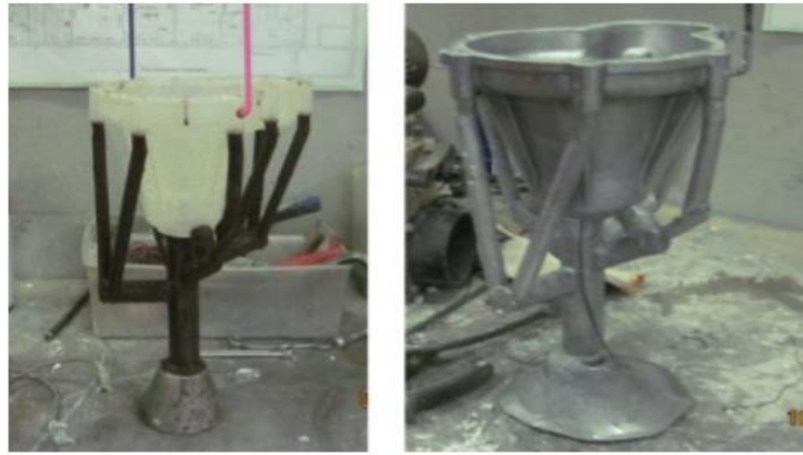
а) құю жүйесі бар SLA – Quick Cast моделі; б) алюминий құйма
