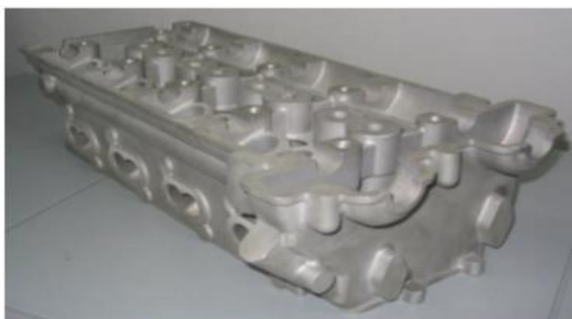
Сурет – 14 Цилиндр бастарының алюминий құйындысы
