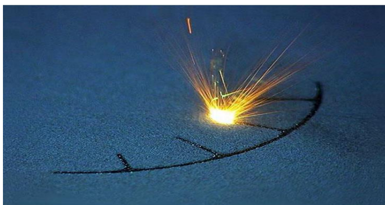
Сурет 33 – Ұнтақ тәрізді металды лазермен еріту
